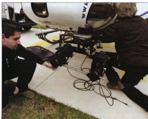
*Gianluca Dentici, DoS, monta (prima volta in Italia) un side by side su un elicottero, con testata speciale per ammortizzare le vibrazioni del velivolo.*
